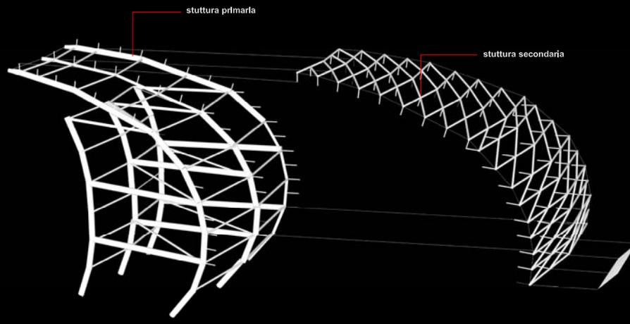
**INTERFACCIA STRUTTURA PRIMARIA-STRUTTURA SECONDARIA: schema di montaggio**
